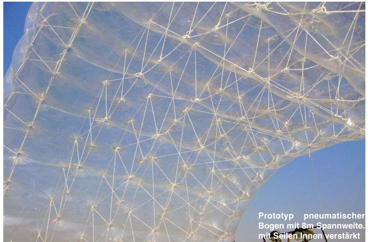
Prototyp pneumatischer Bogen mit 8m Spannweite. mit Seilen Innen verstärkt
