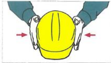
Bei hörbarem „Knacken“ ist der Schutzhelm auszusondern.
