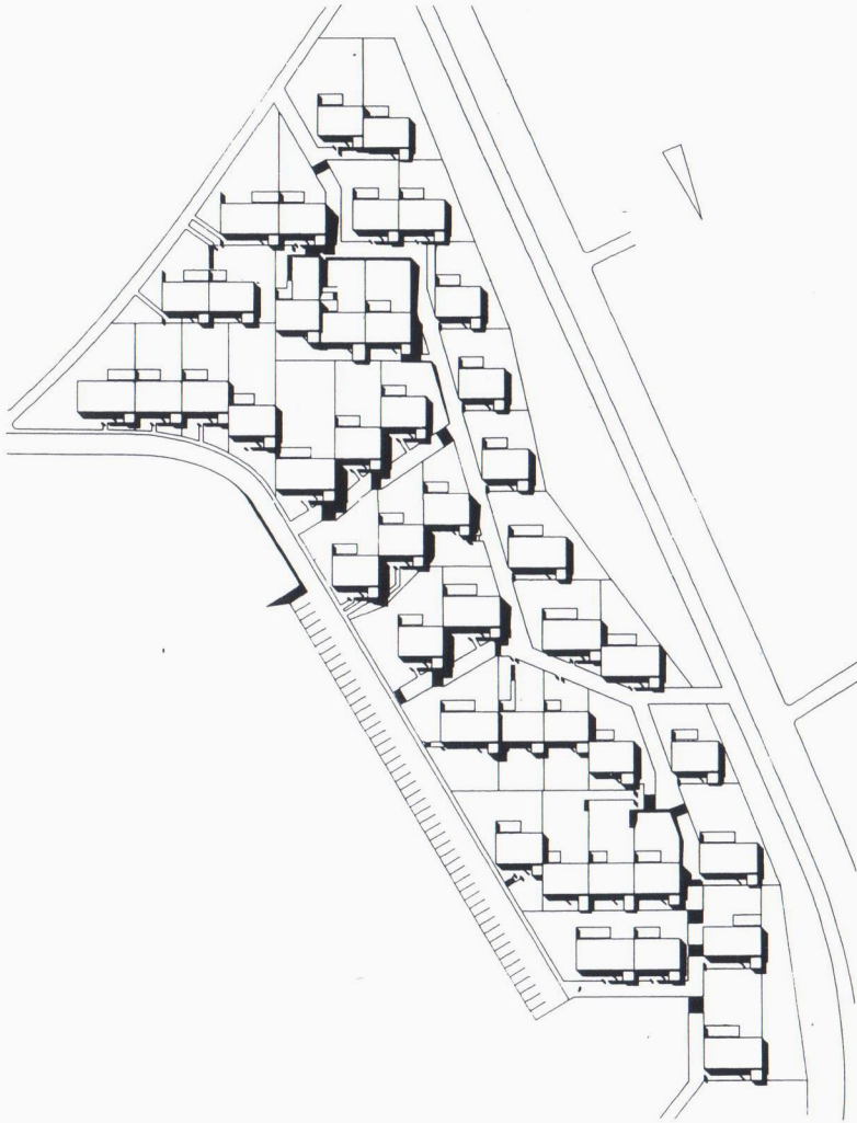
Siedlung Mauerberggasse in Wien, Österreich, 1962-1963 Arch. Roland Rainer Drei variierte Haustypen mit 80 bis 115 qm Wohnfläche
